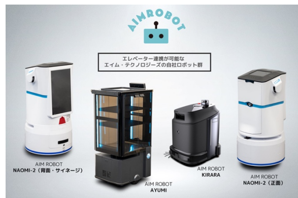
エレベーター連携が可能なエイム・テクノロジーズの自社ロボット群
