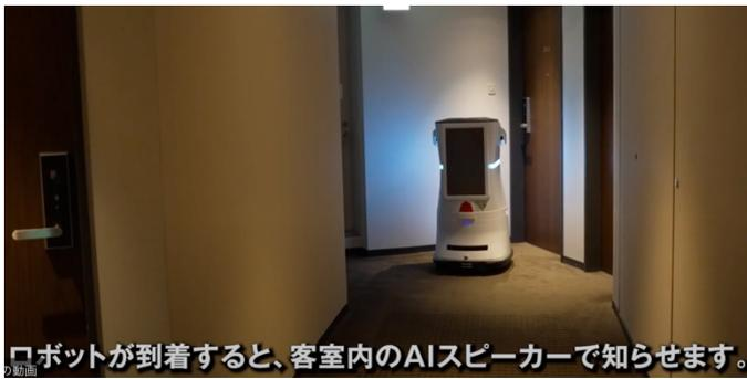
ロボットが到着すると、客室内のAIスピーカーで知らせます。
